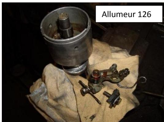
Faire une inspection des ressorts et masselottes d'avance centrifuge, au besoin faire un bon nettoyage avec un spray dégraissant de l'intérieur.
