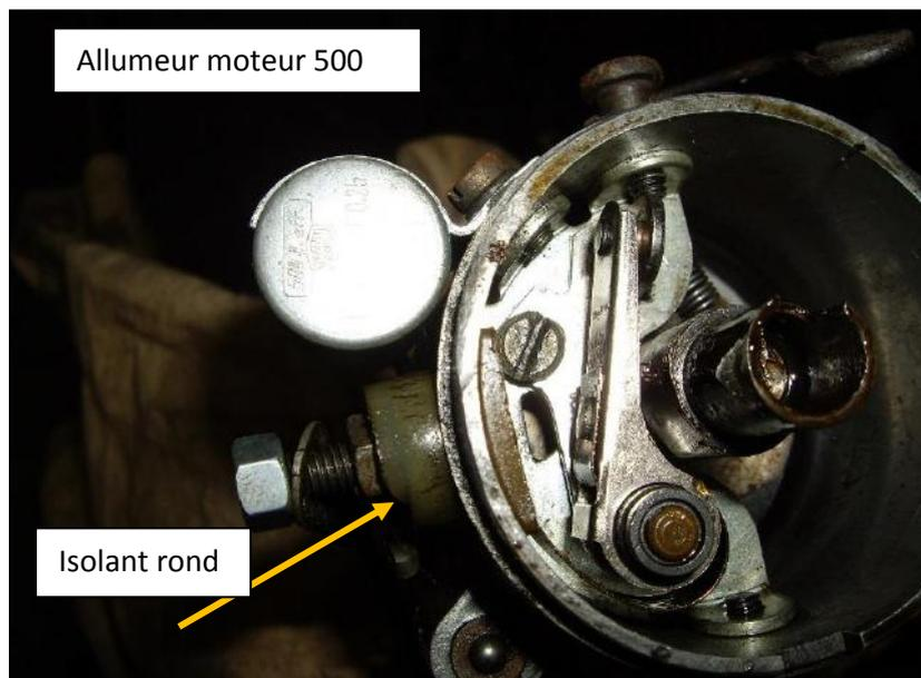
Si votre allumeur vient d'un moteur 126, coupez les deux cosses et retirez le fourreau passe fil en caoutchouc, puis vous récupérez sur les anciens rupteurs, le plastique carré de parois.
