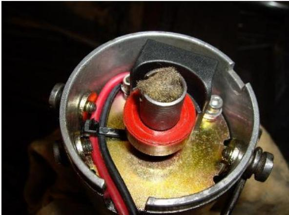
Pour les allumeurs 126 (comme celui de la photo), il est recommandé de bloquer la bague rouge avec un clips de diam 10.
