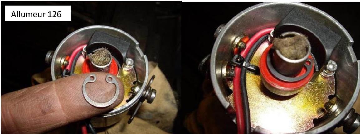
Si votre allumeur vient d'un moteur 500, il suffira de remettre le doigt d'allumage d'origine pour bloquer la bague puis la tête d'allumeur.
