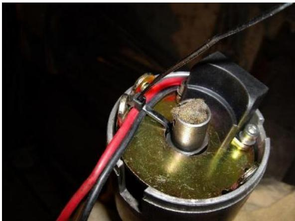
Insérez le plateau et son capteur dans l'allumeur puis le fixer avec les 2 vis munis de leurs clips.
