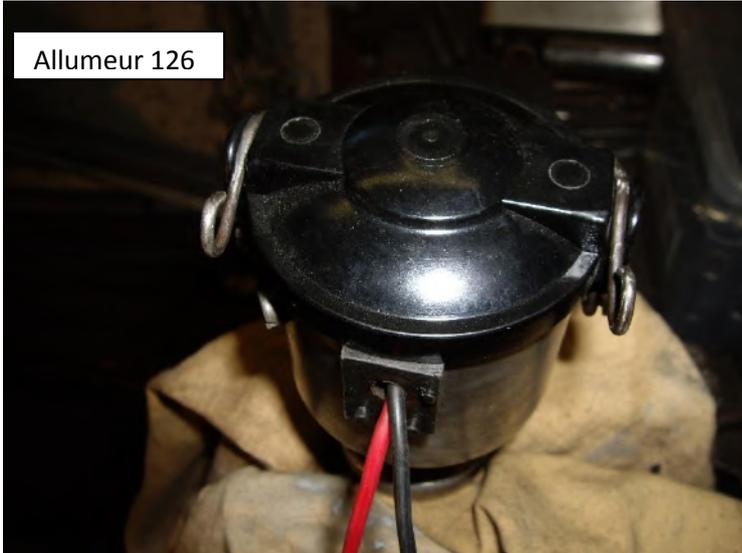
Remettre l'allumeur dans le bloc moteur, sans oublier son joint et en redonnant l'orientation d'avant dépose.
